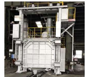
M4台車式 焼入炉 処理能力：15t （令和2年度事業）
